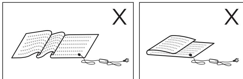
En raison de ses composants, le contrôleur peut légèrement chauffer lorsque le tapis chauffant fonctionne. Ne recouvrez donc jamais le contrôleur et ne le placez pas sur des sources de chaleur lorsqu'il fonctionne.
