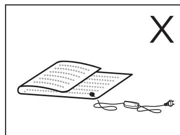
De elektronische onderdelen in de schakelaar kunnen warm worden als het kussen aan staat. Daarom dient de schakelaar niet afgedekt te worden of op het kussen te worden geplaatst.
